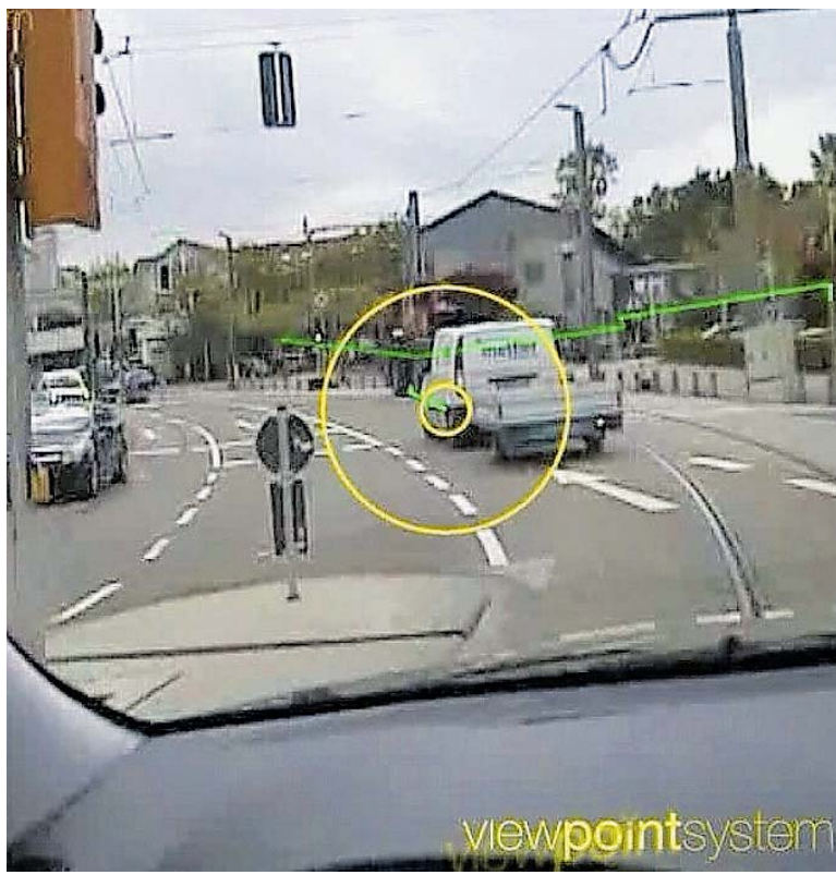
Dank dieser Brille kann das Institut das Blickverhalten des Fahrers auf Straßensituationen wie hier in Riegelsberg auswerten. Zwei Kameras zeichnen das Gesichtsfeld und die Augenbewegungen der Testfahrer auf.
