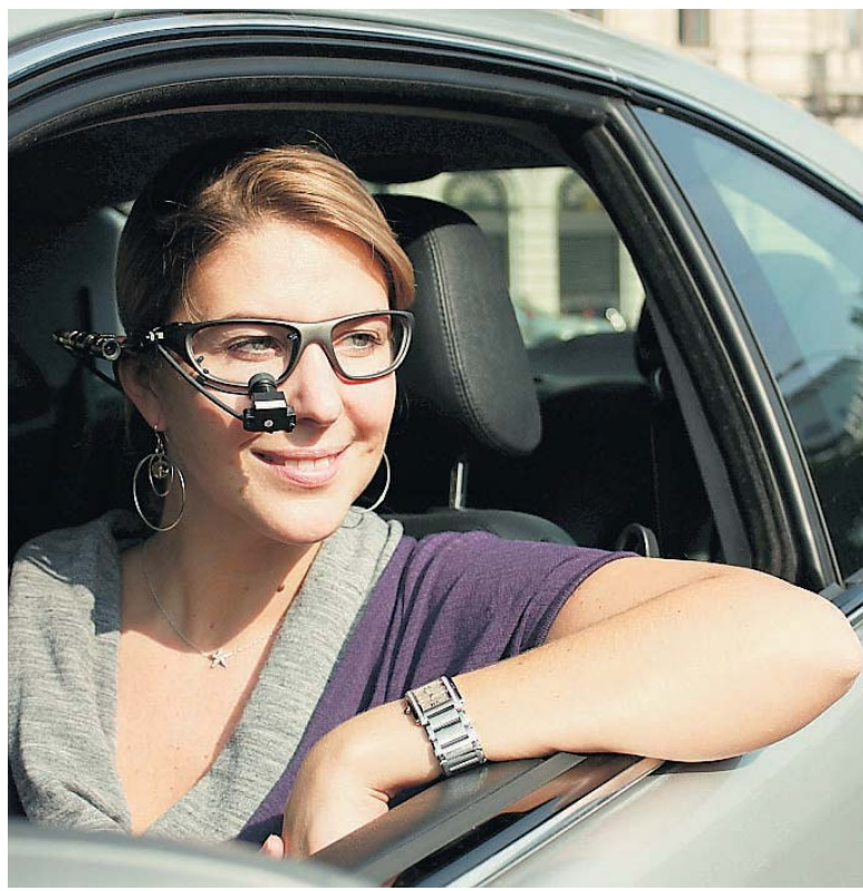
Dank dieser Brille kann das Institut das Blickverhalten des Fahrers auf Straßensituationen wie hier in Riegelsberg auswerten. Zwei Kameras zeichnen das Gesichtsfeld und die Augenbewegungen der Testfahrer auf.
